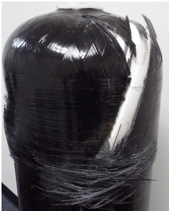
4. Tanque Colapsado - Fibra Totalmente Rota
