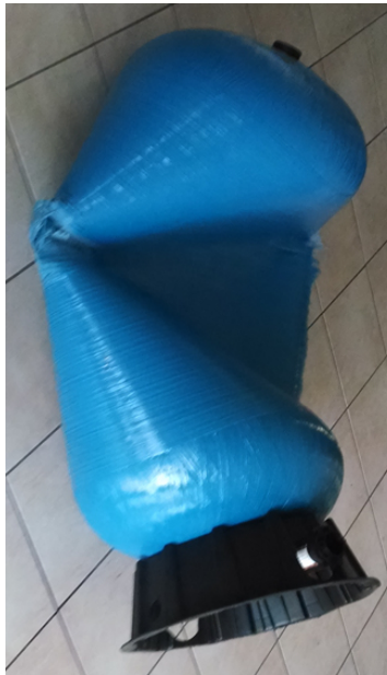
2. Tanque Totalmente Colapsado - Implosión
